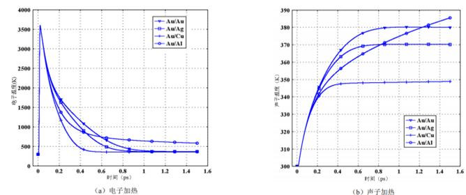
图 3. 不同底层配置对 Au 表面膜系电子、声子加热的影响
