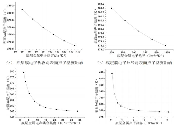
图 2. 底层薄膜热学参数对膜系表面声子温度的影响
