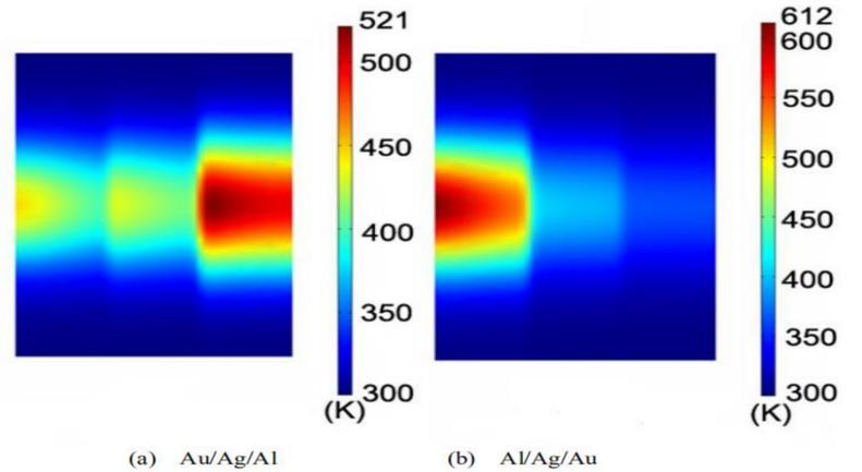
图 1. 三层金属膜中声子温度场分布。图中的色彩代表温度 (红色: 高温, 蓝色: 低温)
